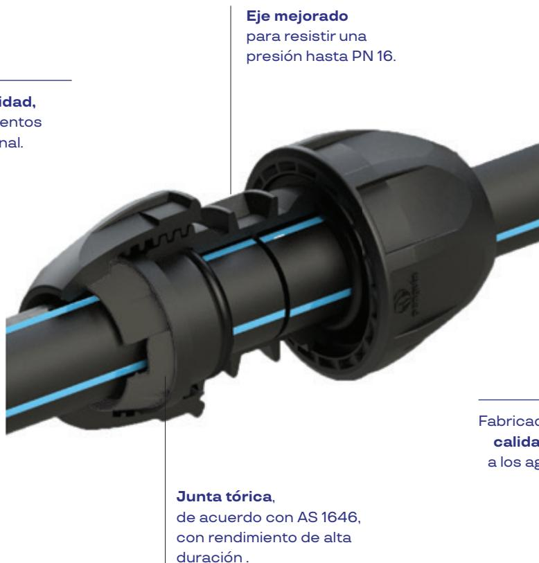
Fabricado con **polipropileno de alta calidad**, resistente a la corrosión y a los agentes químicos y biológicos, de acuerdo con BS 6920.
